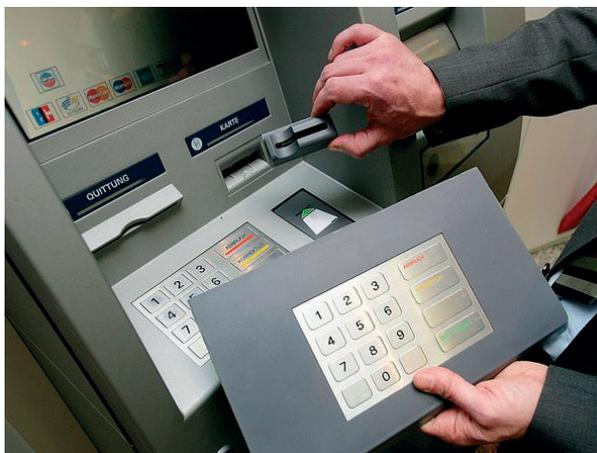
**Рис. 11.** Установка скиммера и накладки на клавиатуру
